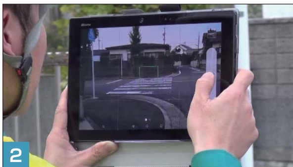
2 路面標示の種類を選択し、対象物の撮影を行う。
